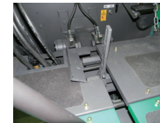
2. Regolazione della bombatura a cricchetto
