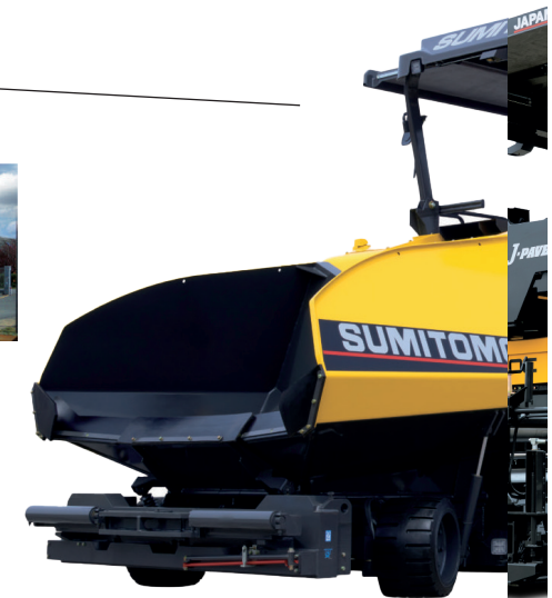
6. Paratie frontali estendibili (Azionamento idraulico)
